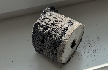
Résultat du sondage: Mur moellons 50 cm, vide 5 cm, brique d'escarville 4 cm, crépi 0,5 cm
