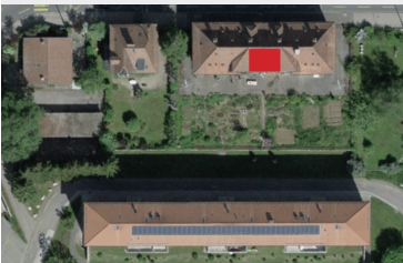
Panneaux photovoltaïques d'un seul tenant, inscrits dans un rectangle bien délimité (10kWp possible dans ce cas).
